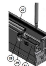
Laufkammer für Insektenschutz mit Schrägbürste + dicke Bürste
