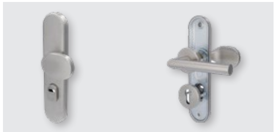
A 70 E Edelstahl (E) Kombi-Sicherheitsgarnitur: außen Langschild, innen Ro- sette, ES1 geprüft, RC 2 geeignet. Kernziehschutz, außen gehärtete Stahlunterkonstruktion. Drücker-Drücker AI 69 E, Türknopf A 70 E
