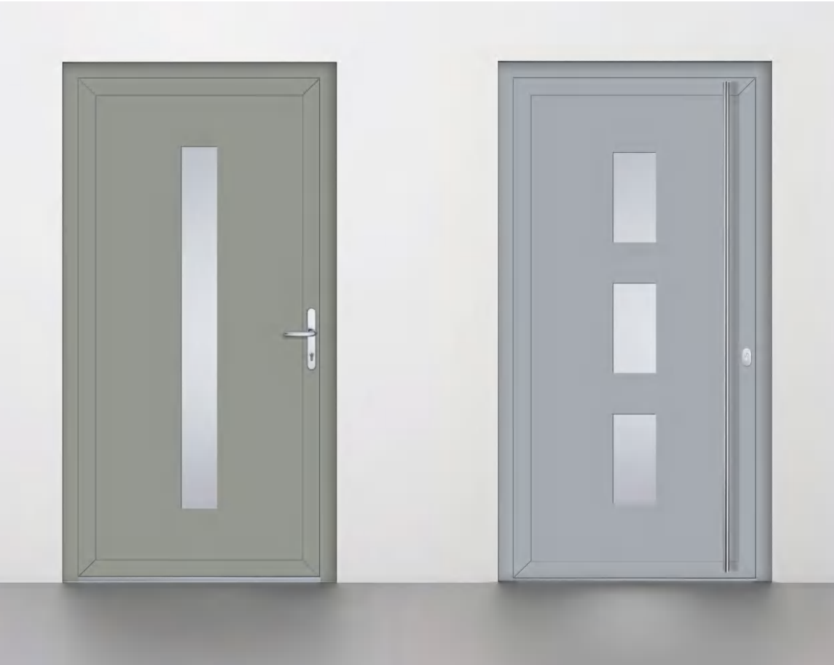
ALUTEC 504 Aluminium HA 504 ABBILDUNG. RAL 7030 Steingrau. Wärmeschutzglas. Verbundsicherheitsglas beidseitig. Satinato Weiß. Glasausschnitt: 150 x 1530 mm. GRIFF: Beidseitig Drücker Alu Silber ANDN/INDN.
