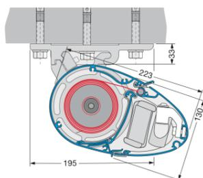
Durch die spezielle Bauweise, ist eine Befestigung für Wand als auch Decke (bis 80° Neigungswinkel - einmalig bei Montage einstellbar) gewährleistet. Die ideale Lösung für Sicht- und Sonnenschutz speziell bei tiefem Sonnenstand.
